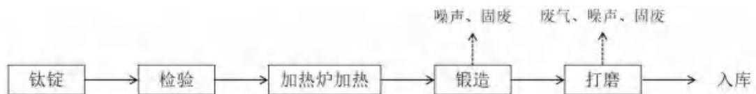
图 2-2 工艺流程及产污环节图
