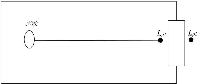
图 4-1 室内声源等效为室外声源图例
