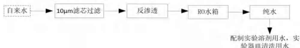
图 2-1 纯水制备工艺
