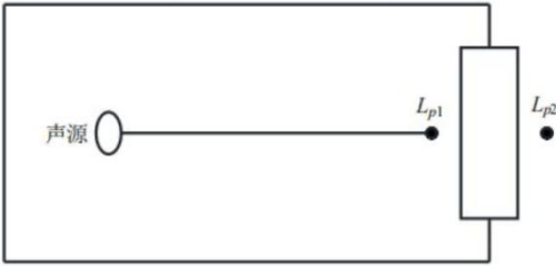
图 4-1 室内声源由室内向室外传播示意图
