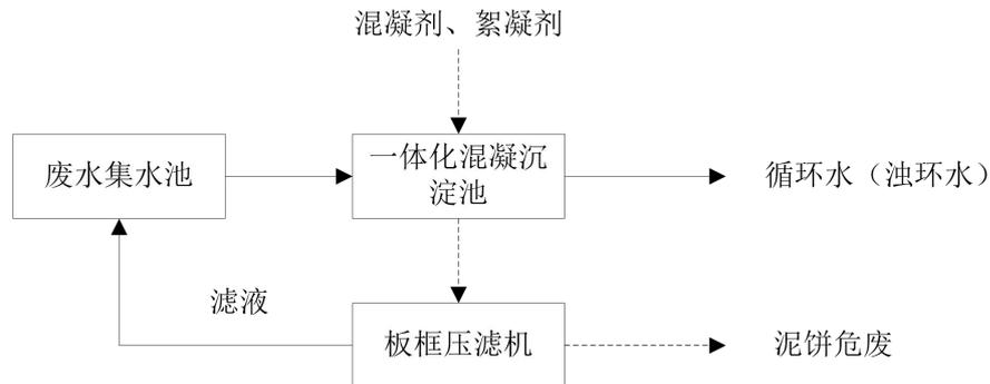
图 5 废水处理工艺流程图
