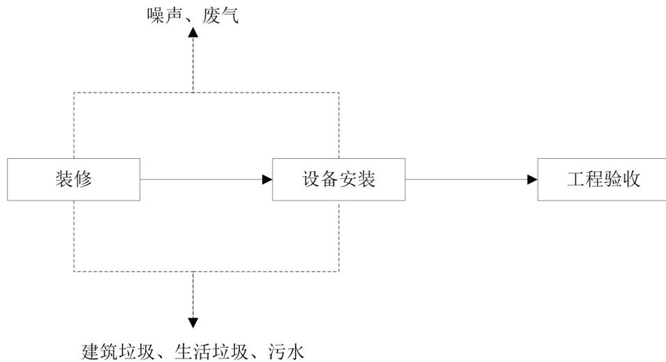
图 2 施工期工艺流程及产污环节图
