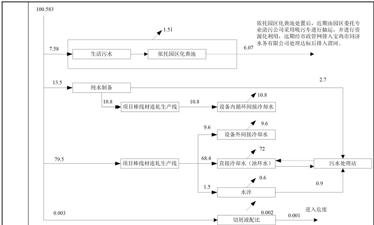
图1 项目水平衡图 单位: m<sup>3</sup>/d
