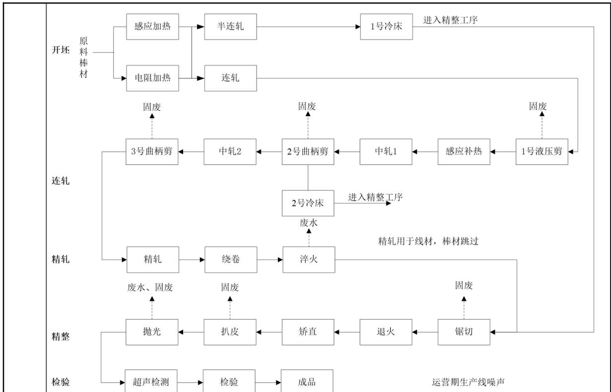
图3 运营期棒线材连轧生产线生产工艺及产污环节分析图
