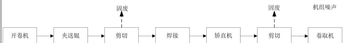
图 6 箔材平整机组工艺流程及产污环节图
