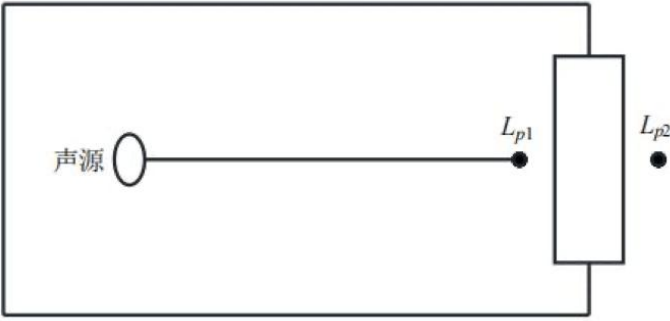
图 4-1 室内声源等效为室外声源图例
