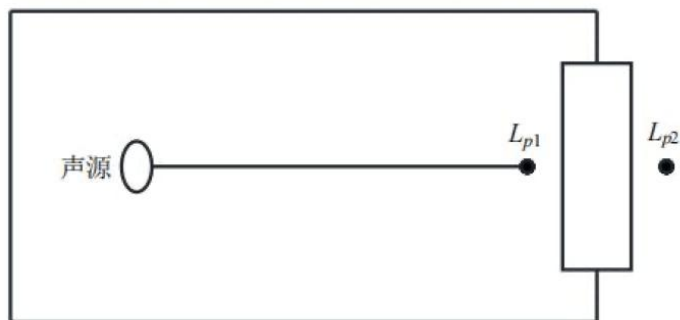
图 4-1 室内声源等效为室外声源图例
