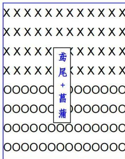
图 2-2 水平潜流人工湿地单元植物配置方式
