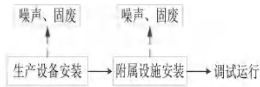
图 2-3 项目施工期工艺流程及产污环节图
