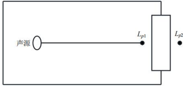
图 4-1 室内声源等效为室外声源图例
