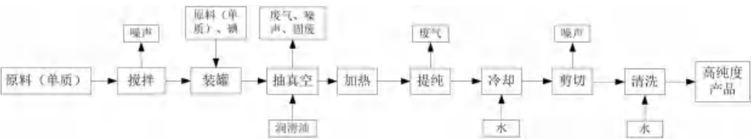
图 2—3 提纯生产工艺流程及产污环节图
