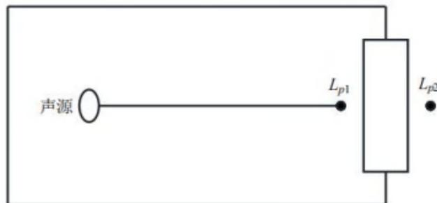
图 4-1 室内声源等效为室外声源的图例
