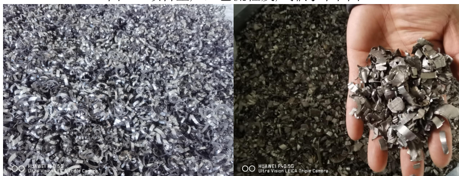
图 2-3 项目破碎工序前后对比图
