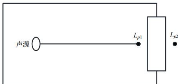
图 4-2 室内声源等效为室外声源图例
