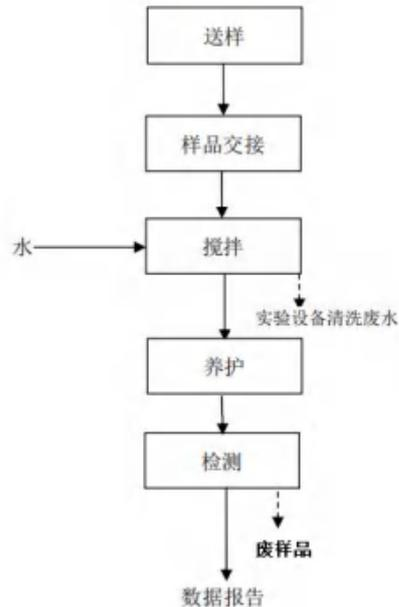
图 2-4 混凝土、砂浆类检测流程
