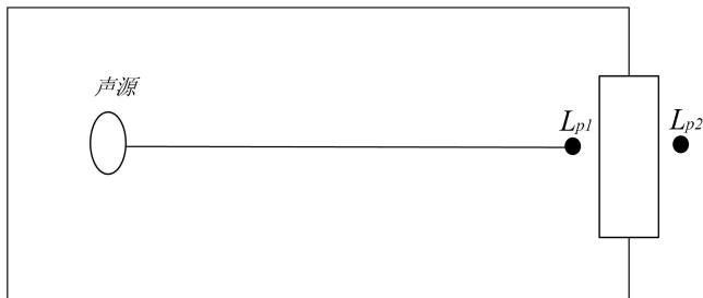
图 4-1 室内声源等效为室外声源的图例
