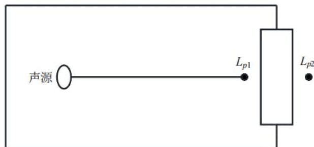
图 4-1 室内声源等效为室外声源图例
