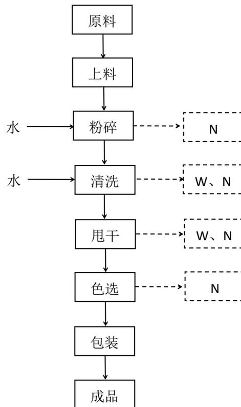
图 2-2 生产工艺流程及产污环节图
