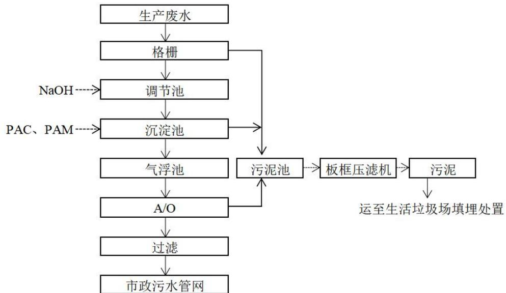
图 4-1 污水处理工艺流程图
