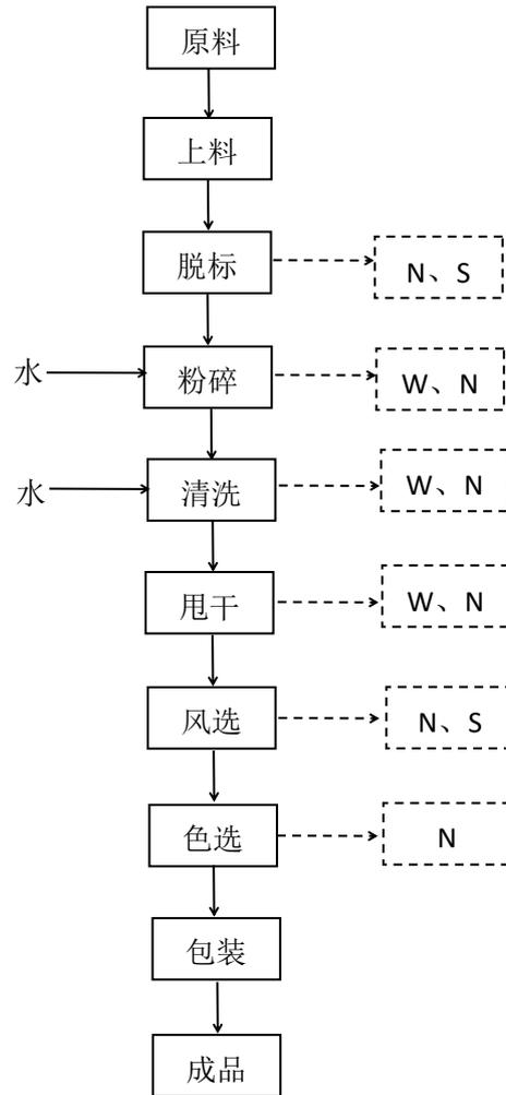
图 2-3 生产工艺流程及产污环节图
