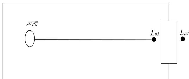
图 4-2 室内声源等效为室外声源的图例
