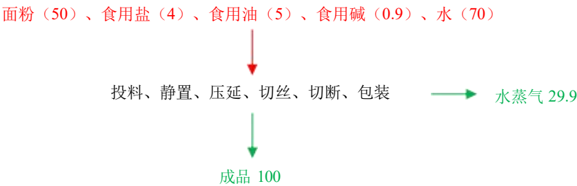
图 2-17 冻熟面生产物料平衡图 (t/a) 图例： —→ 投入 —→ 产出
