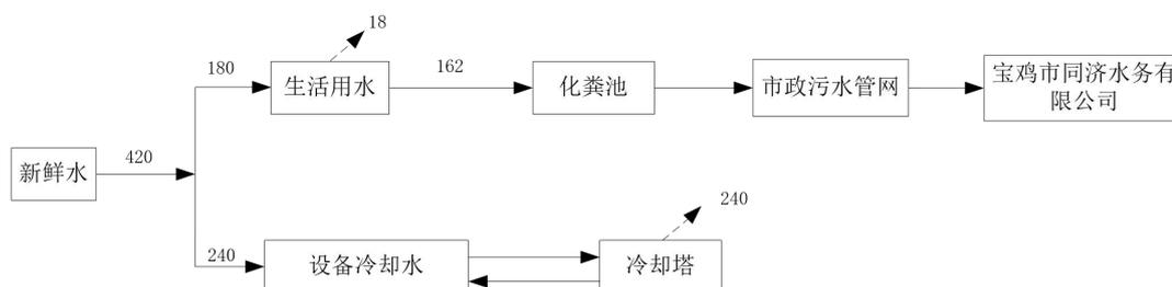
图 2-1 项目水平衡图 ( $\text{m}^3/\text{a}$ )
