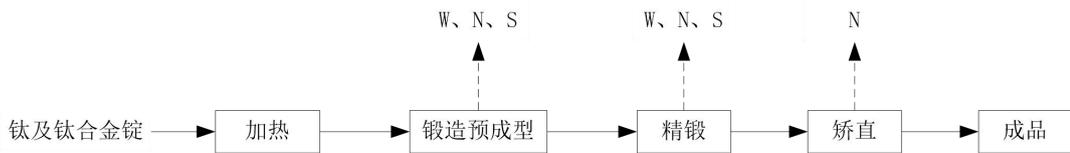
图 2-3 项目运营期工艺流程及产污环节图
