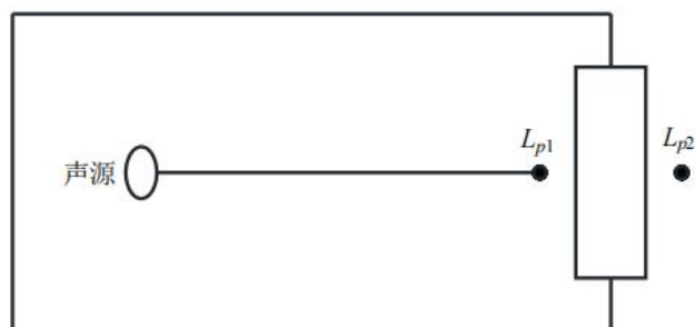
图 4-2 室内声源等效为室外声源图例
