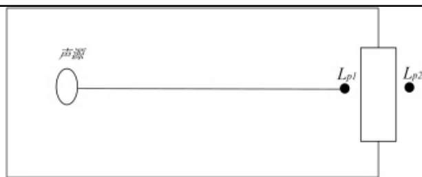
图 4-2 室内声源等效为室外声源图例
