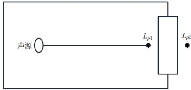
图 4-1 室内声源等效为室外声源图例
