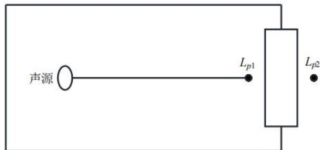
图 4-1 室内声源等效为室外声源图例
