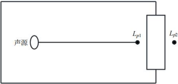
图 4-3 室内声源等效为室外声源图例
