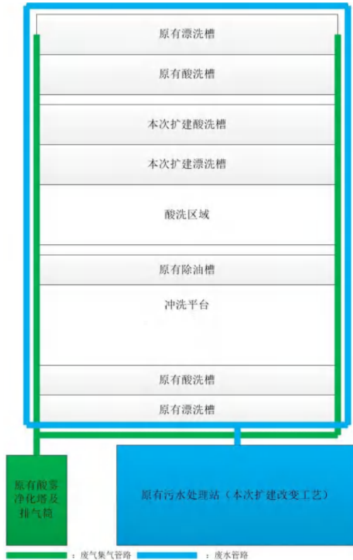
图 4-2 本项目废气、废水收集示意图
