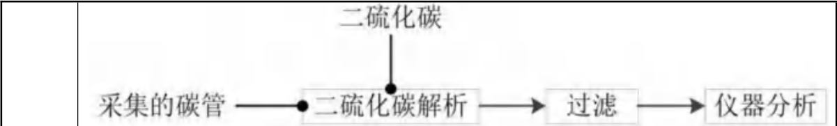
图 2-7 分析空气中的苯系物工艺流程及产污节点图
