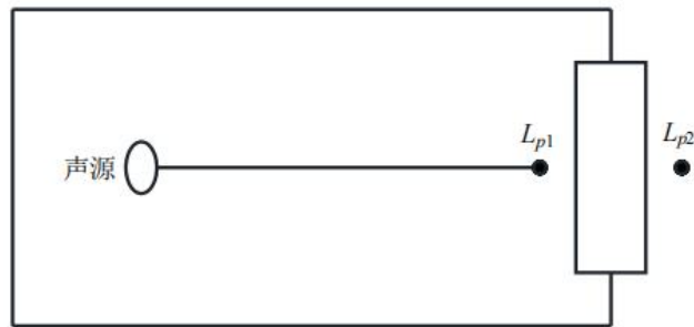
图 4-1 室内声源等效为室外声源图例
