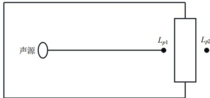
图 4-1 室内声源等效为室外声源图例
