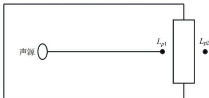
图 4-1 室内声源等效为室外声源图例
