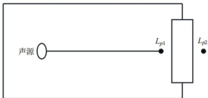
图 4-1 室内声源等效为室外声源图例
