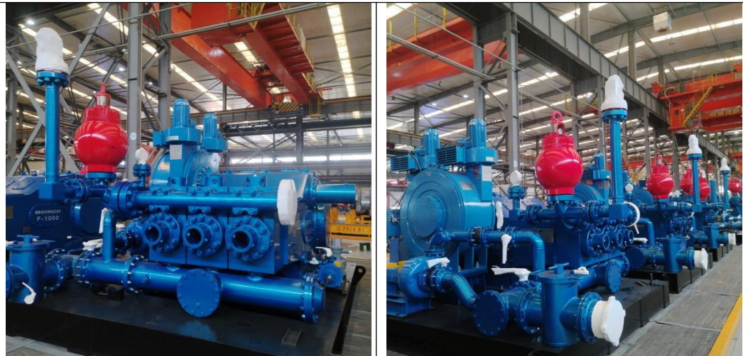
钻井泵组设备
