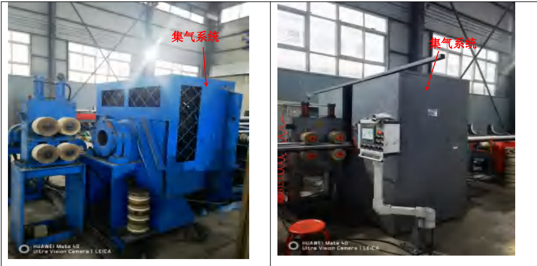
图 4-1 项目砂带抛光机自带收尘设备
