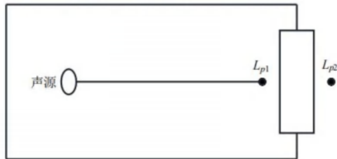
图 4-2 室内声源等效为室外声源图例
