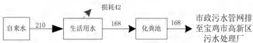
图 2-2 项目水平衡图（m 3 /a）
