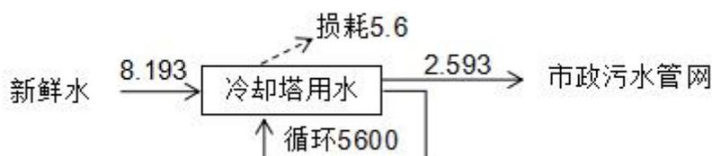
图2-1本项目水平衡图（单位： $\text{m}^3/\text{d}$ ）
