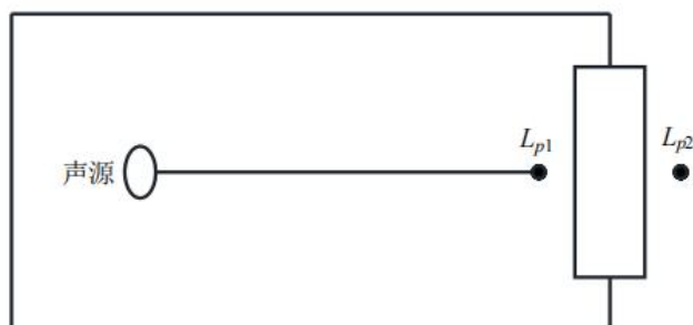
图 4-1 室内声源等效为室外声源图例
