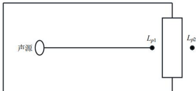
图 4-1 室内声源等效为室外声源图例
