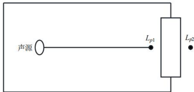
图 4-1 室内声源等效为室外声源图例
