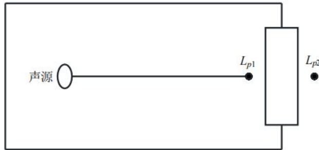
图 4-1 室内声源等效为室外声源图例
