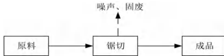
图 2-5 电极锯切生产工艺流程及产污环节图
