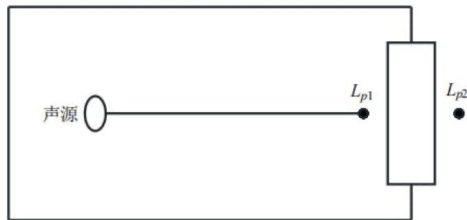
图 4-1 室内声源等效为室外声源图例
