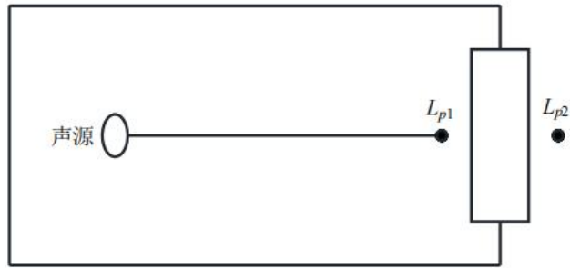
图 4-2 室内声源等效为室外声源图例
