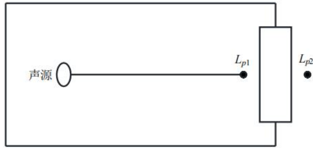
图 4-2 室内声源等效为室外声源图例
