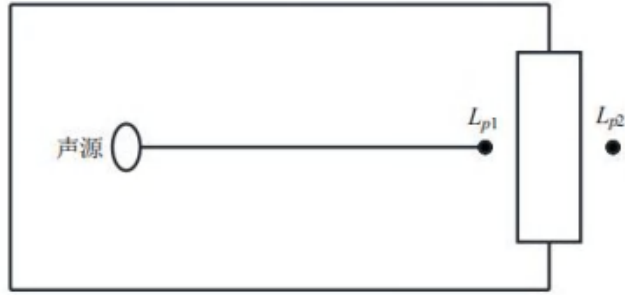
图 4-2 室内声源等效为室外声源图例
