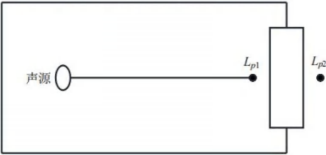
图 4-1 室内声源等效为室外声源图例
