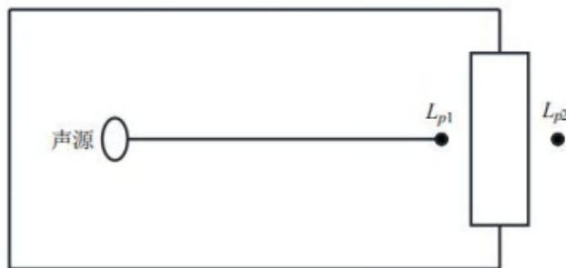
图 4-2 室内声源等效为室外声源图例
