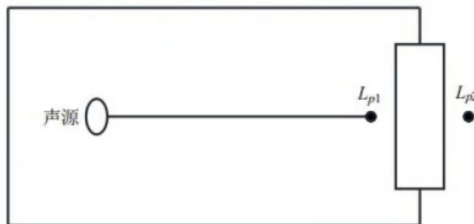
图 4-1 室内声源等效为室外声源图例
