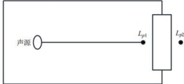
图 4-1 室内声源等效为室外声源图例
